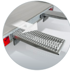
Stahl Auffahrampen von 250 cm
