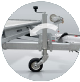
Zubehör: Klappbares Stützrad ermöglicht Weiterfahrt
