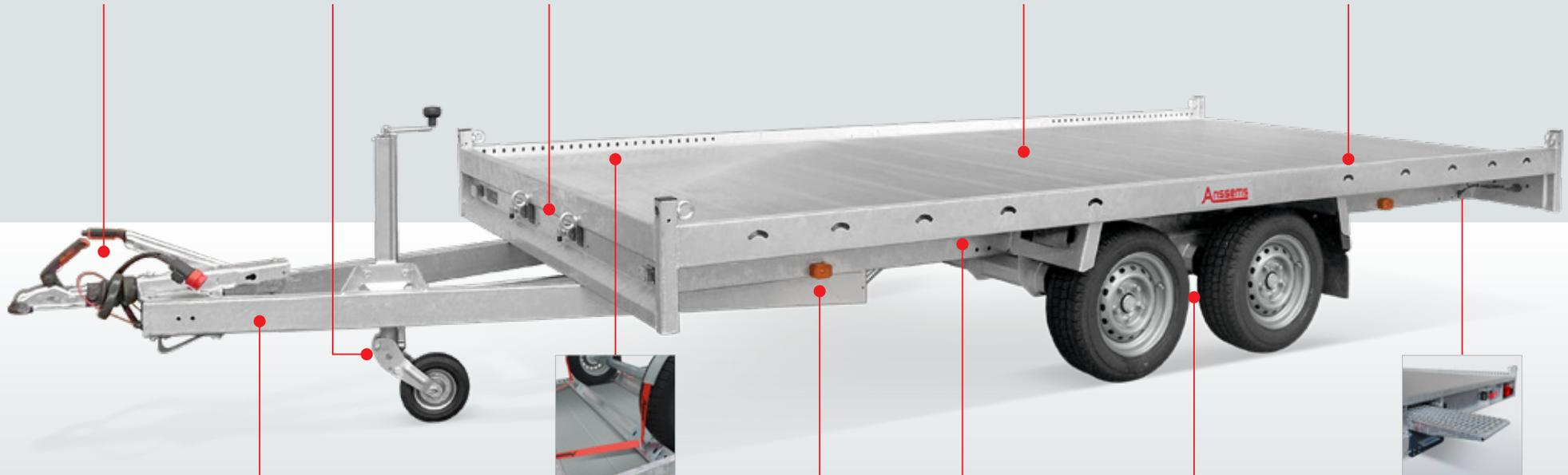
Lange Deichsel aus Rechteckrohrprofil mit einer freien Länge von 145 cm
