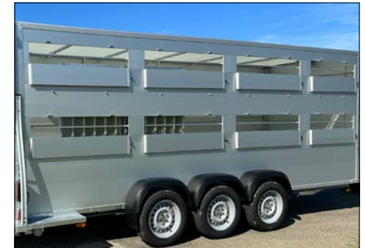
Ventilatieluien zijkant • Side ventilation hatches • Seitliche Lüftungsluken • Trappes de ventilation latérales
