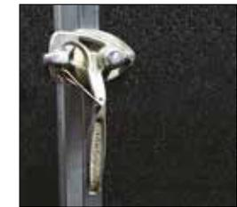
Heckklappenverschluss mit Sicherheitsfeder, 180° drehbar
