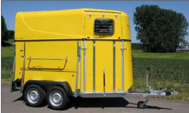
Probleme sind da, um gelöst zu werden - der Mikado ist so eine Lösung. Unerfahrene oder problematische Pferde sind mit dieser funktionellen und attraktiven Hän-gervariante bestens bedient. Die flache Einstiegsrampe, die mittig geteilte Trennwand und der besonders große Vorderausstieg machen das Verladen unkompliziert und problemlos.
