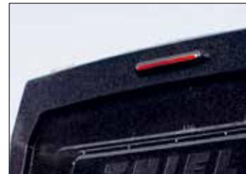
**Bremsleuchte** zusätzlich oberhalb Heckklappe
