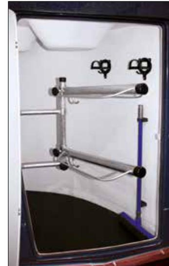
**Sattelhalter** schwenkbar und höhenverstellbar (Explorer Serie)
