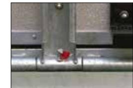
Vier stabile Heckklappenscharniere mit Schmiernippel
