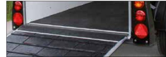
Schmutzschleuse am Übergang Boden/ Heckklappe
