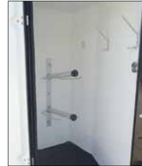
Ausführung mit Sattelkammer. Sattelhalter mit breiter Auflage, Trensenhalter und Zwangsentlüftung, Türe abschließbar
