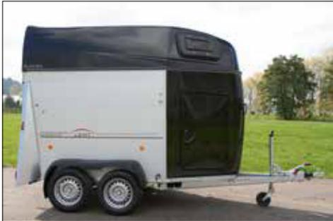
Von jedem nur das Beste – der Materialmix aus Vollpolyester, Aluminium und AluPlast® macht den Primus Alu nahezu unverwundlich. Schlagfeste Seitenwände aus Aluminium-Doppelkammerprofil, ein Bugteil aus Vollpolyester und die bewährte AluPlast® Bodengruppe zusammengesetzt zur eleganten Primus-Optik bieten das Maximum an Langlebigkeit in edlem Design.
