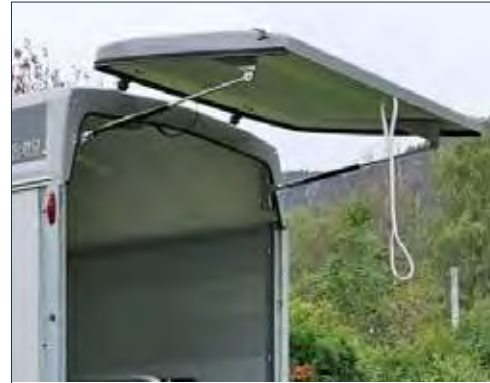
Vaste achterklep polyester • Hard top rear cover polyester • Polyester Trittschutz • Protège-marche en polyester
