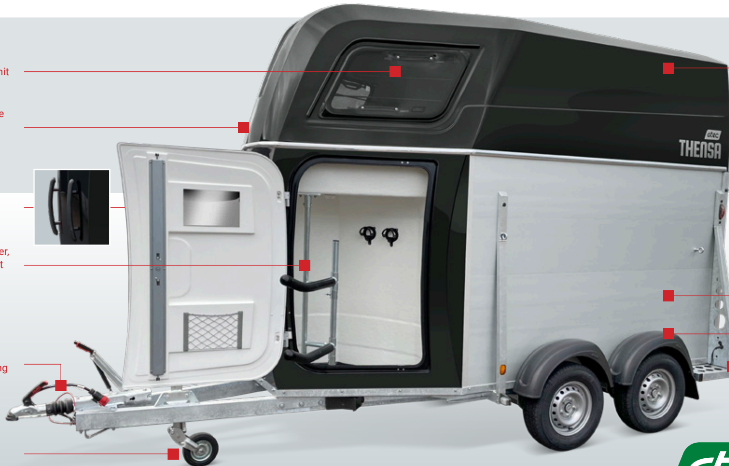
Höhenverstellbare Brust- und Heckstangen mit Panik-Entriegelung
