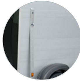
Aluminium-Seitenwände mit Verstärkungsstützen
