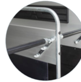
Höhenverstellbare Brust- und Heckstangen mit Panik-Entriegelung
