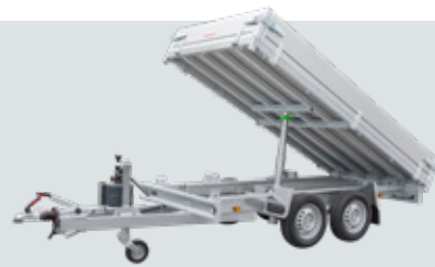
KSX Rückwärtskipper oder 3-Seitenkipper Handpumpe
